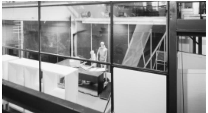
En los ensayos realizados se efectúan mediciones de temperatura, velocidades residuales,... y se efectúan impulsiones con humo para visualizar con nitidez la distribución de aire en la sala.
